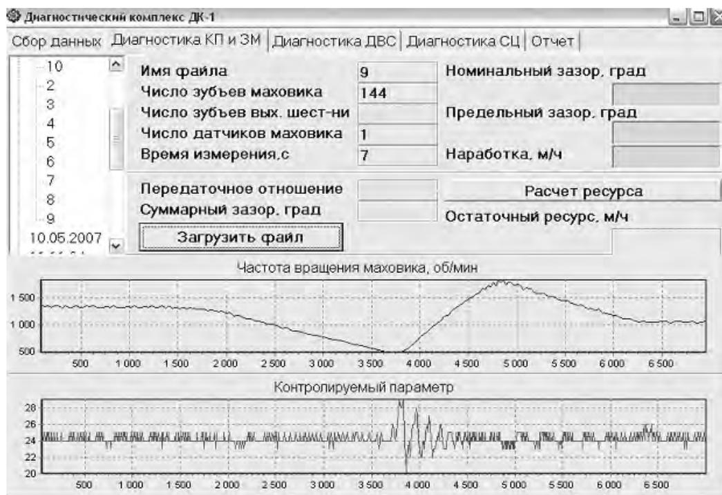
Рис. 9. Отображение на экране монитора результатов диагностики при тестовом воздействии вида «торможение–разгон двигателем»
