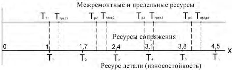
Рис. 1. Схема зависимости между ресурсом упрочненной детали – ресурсом сопряжения – межремонтным ресурсом машины:  $T_{р1}, T_{р2}, \dots, T_{рi}$  – межремонтные ресурсы машины;  $T_{пред1}, T_{пред2}, \dots, T_{предi}$  – предельные ресурсы машины;  $T_1, T_2, \dots, T_i$  – ресурсы восстановленной машины
