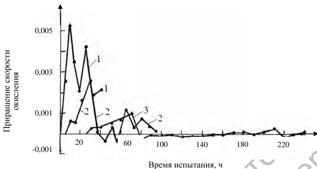
Рис. 5. Зависимость приращения скорости окисления \Delta V_{\text{Кп}} от времени и температуры испытания частично синтетического трансмиссионного масла CONSOL TRANS ЛЮКС 75W-90 GL-5: 1 – 150 °C; 2 – 140 °C; 3 – 130 °C
