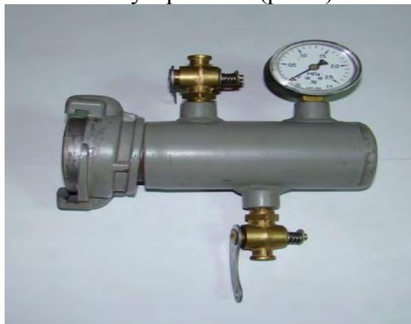
Рис. 1. Устройство для контроля пожарных кранов на водоотдачу
