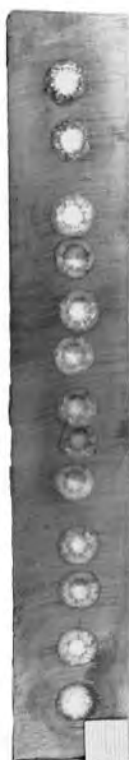
Рис. 4. Образец для проведения оптико-эмиссионного анализа химического состава
