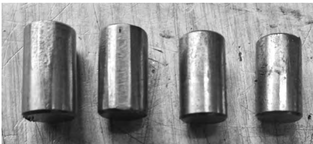
Рис. 2. Следы питтинга на поверхностях роликов муфты свободного хода
