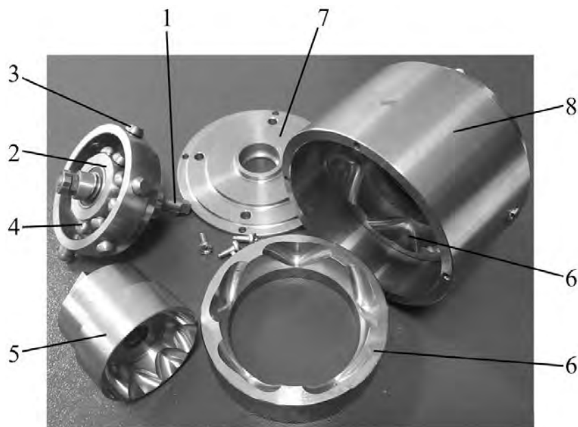
Рис. 1. Основные узлы и детали СРП: 1 – ведущий вал; 2 – сателлит; 3 – ролики наружного ряда; 4 – ролики внутреннего ряда; 5 – ведомый вал с ведомым кулачком, на торце которого выполнена периодическая замкнутая беговая дорожка; 6 – наружные кулачки, закрепляемые в корпусе, образующие неподвижную беговую дорожку; 7 – крышка корпуса; 8 – корпус
