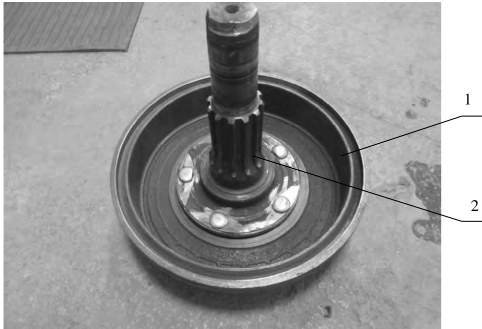
Рис. 5. Тормозной барабан в сборе с полуосью бортового редуктора: 1 – тормозной барабан; 2 – полуось
