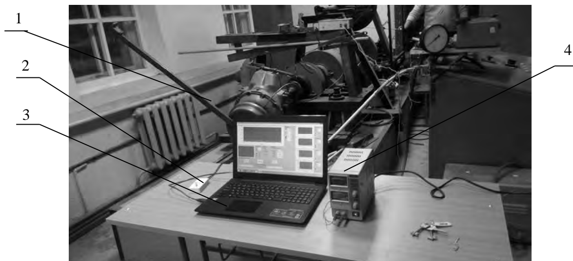
Рис. 9. Оборудование испытательного стенда, использовавшееся для контроля измеряемых параметров – тормозного момента и усилия на педали привода: 1 – рычаг поворота барабана; 2 – прибор беспроводной передачи данных; 3 – компьютер отображения и фиксации измеряемых параметров; 4 – источник питания
