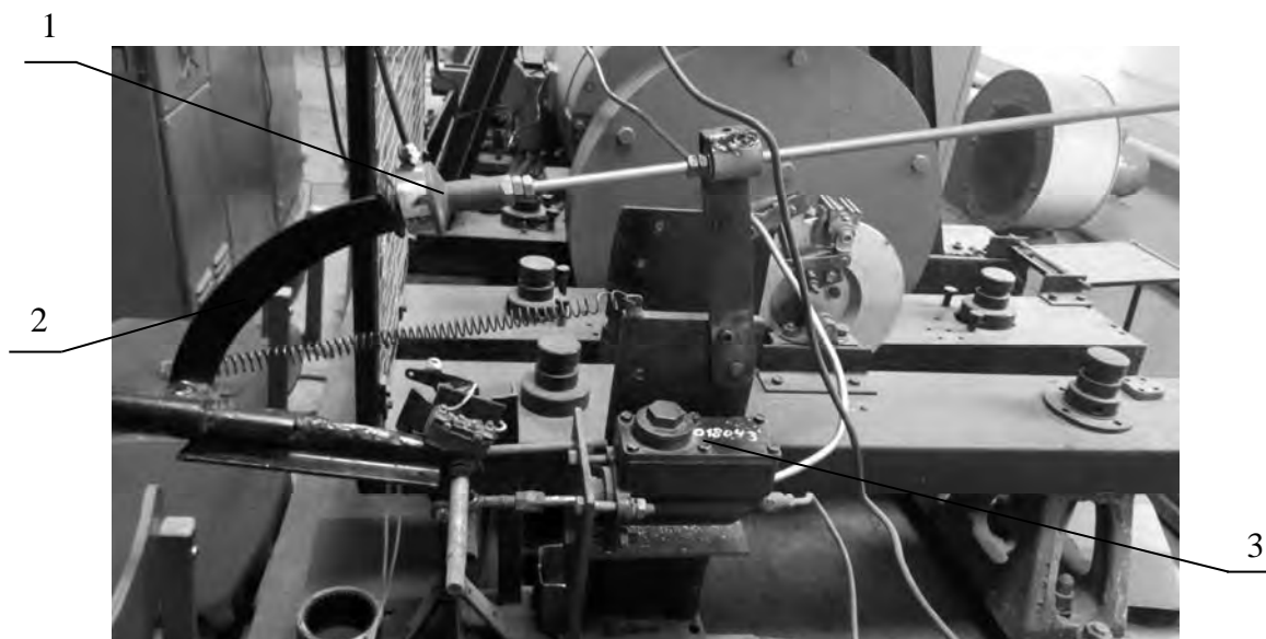
Рис. 8. Привод гидравлический колесного тормоза с датчиком фиксации усилия на педали привода: 1 – датчик измерения усилия, прикладываемого к педали гидропривода; 2 – педаль гидропривода; 3 – гидравлический привод тормозного механизма
