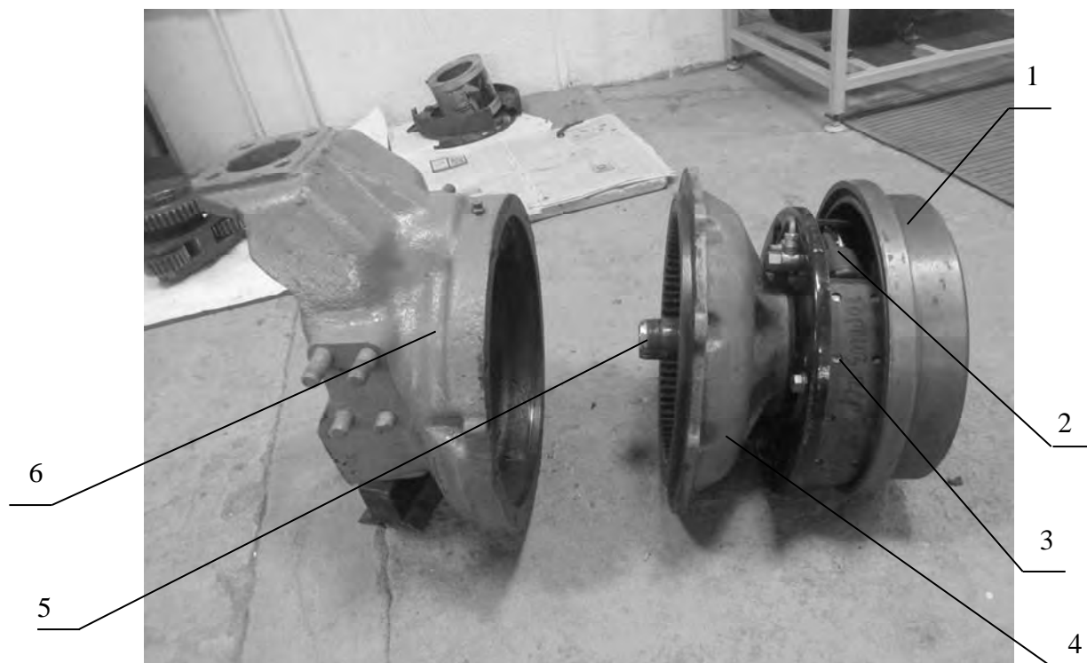
Рис. 4. Колесный тормоз передних колес трактора «Беларус-1221» в сборе с корпусом редуктора: 1 – тормозной барабан; 2 – тормозной цилиндр; 3 – тормозная колодка; 4 – крышка редуктора; 5 – полуось; 6 – корпус редуктора
