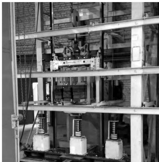
Рис. 7. Стенд для испытаний лифтовых ловителей ОАО «Могилевлифтмаш»
