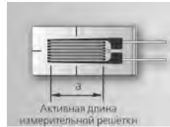
Рисунок 7.16 – Структура линейных тензорезисторов типа 1-LY15-10/120
