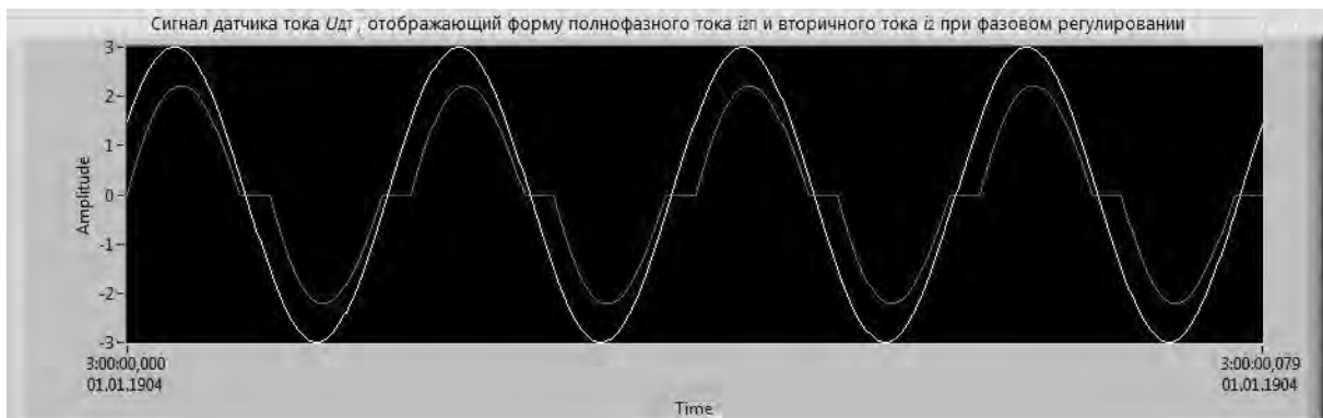
Рисунок 7.20 – Сигналы датчика тока U_{дт} при полнофазном включении тока i_{2п} и при фазовом регулировании i_2
