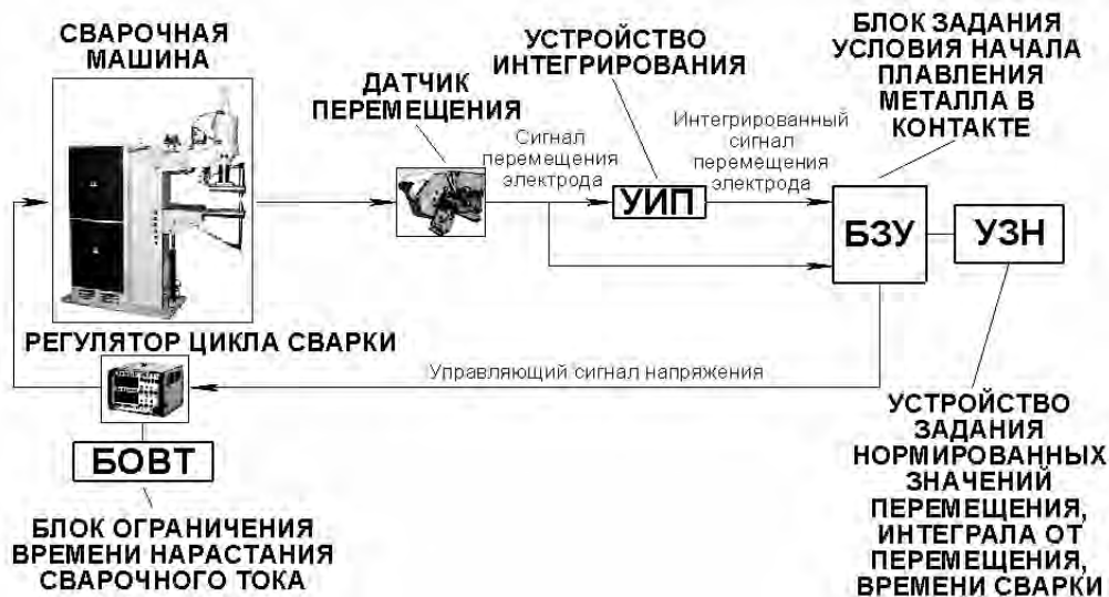
Рисунок 1.22 – Структурная схема системы активного контроля процесса контактной точечной сварки по перемещению электрода
