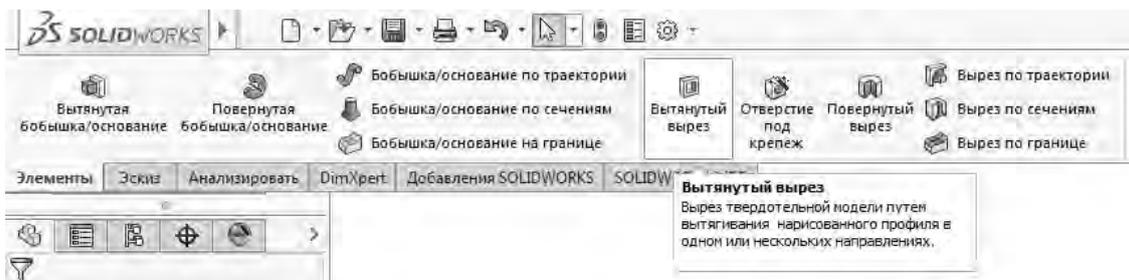
Рисунок 20 – Панель инструментов «Элементы»
