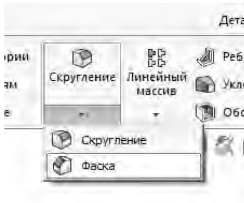
Рисунок 26 – Команды «Скругление», «Фаска» панели инструментов «Элементы»
