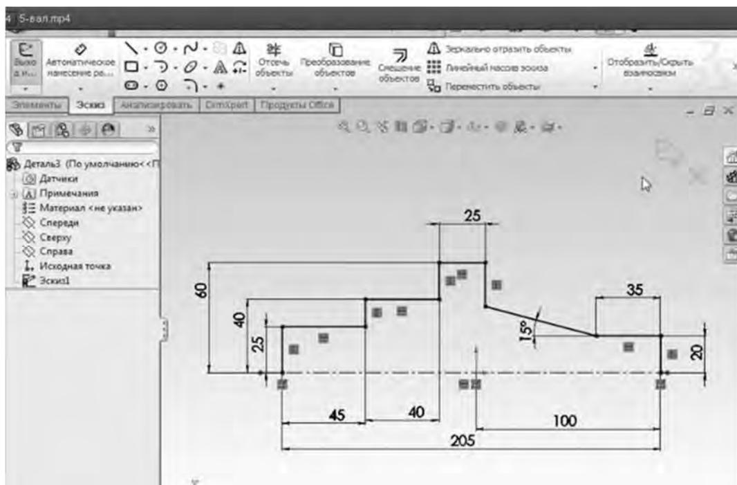
Рисунок 24 – Пример эскиза вала с проставленными размерами
