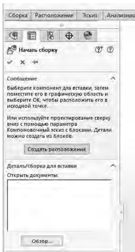
Рисунок 28 – Диалоговое окно для добавления базового компонента
