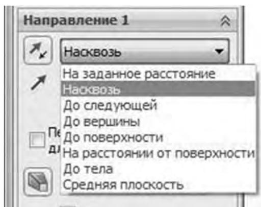
Рисунок 21 – Задание параметров элемента «Вытянутый вырез»
