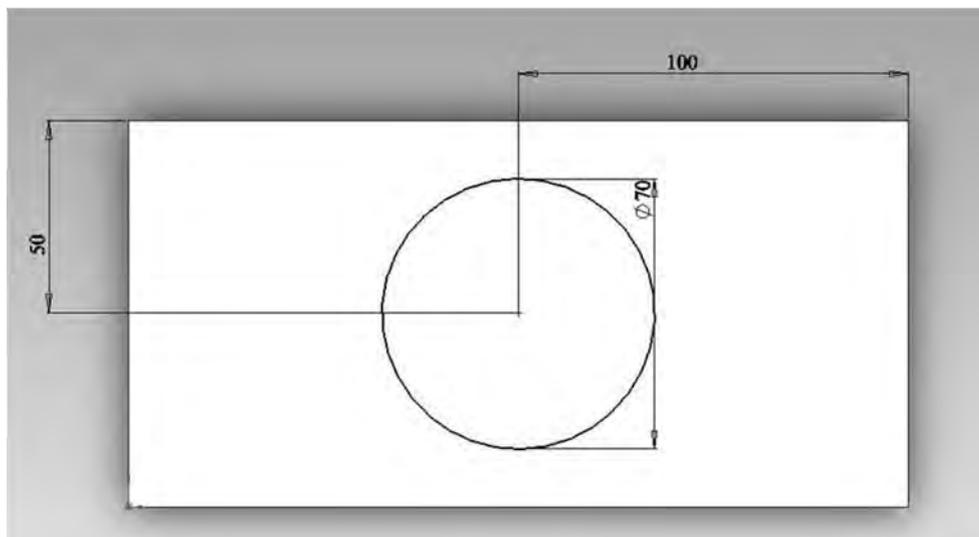
Рисунок 17 – Эскиз бобышки с проставленными размерами
