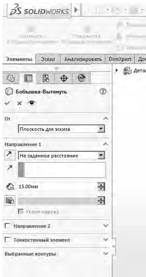
Рисунок 14 – Задание параметров элемента «Вытянутая бобышка/основание»
