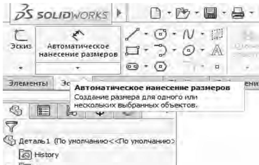
Рисунок 10 – Команда «Автоматическое нанесение размеров» на панели инструментов «Эскиз»
