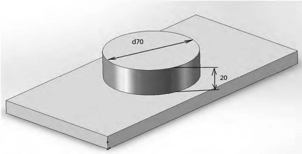
Рисунок 15 – Трехмерная модель основания с бобышкой круглой формы
