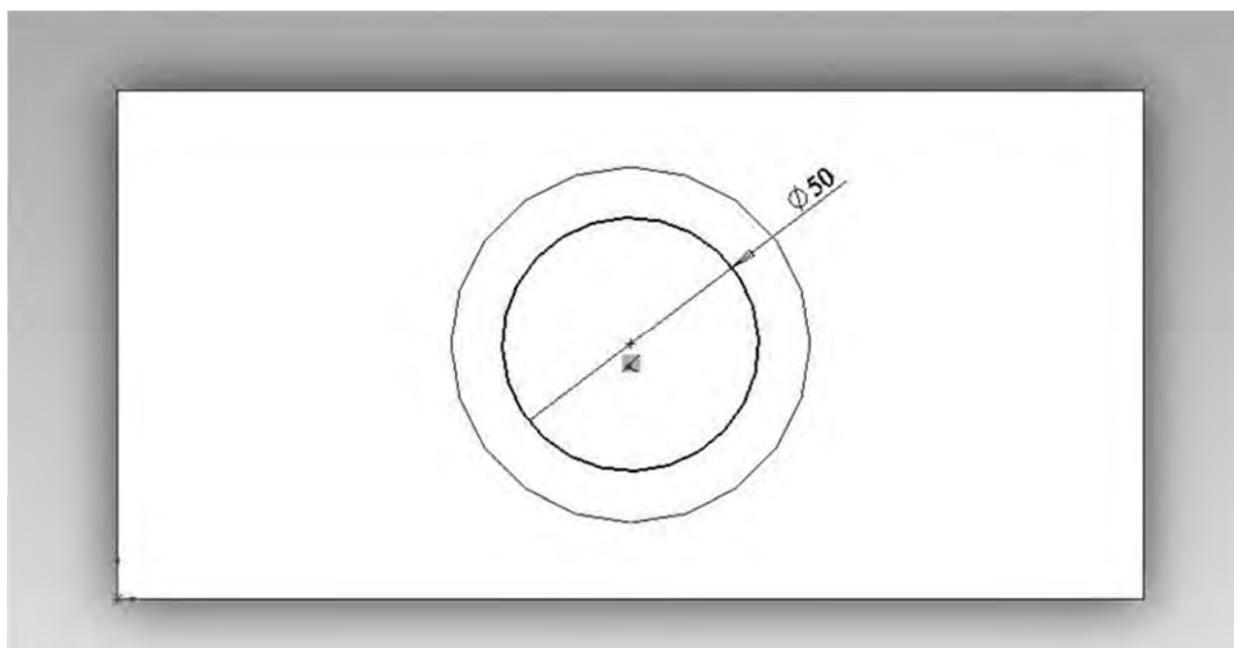
Рисунок 19 – Эскиз бобышки с отверстием и проставленными размерами
