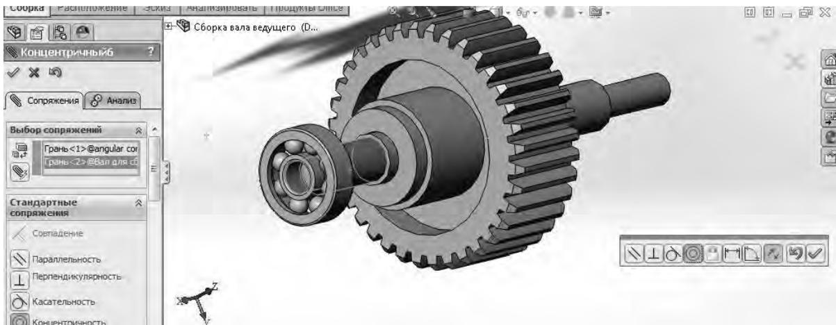
Рисунок 31 – Установка подшипника на вал
