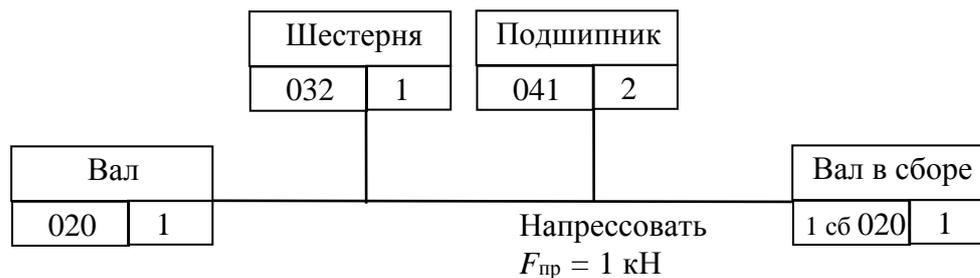
Рисунок 2.9 – Пример оформления схемы сборочной операции
