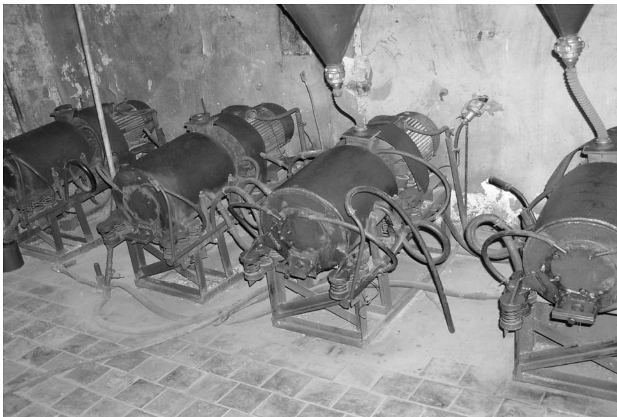
Участок реакционного механического легирования (промышленные механореакторы-вибромельницы инерционного типа с объемом помольной камеры 30 дм 3 )
