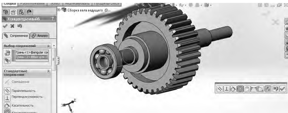
Рисунок 31 – Установка подшипника на вал
