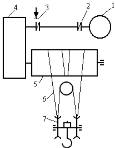
Рисунок 7.1 – Кинематическая схема механизма подъёма
