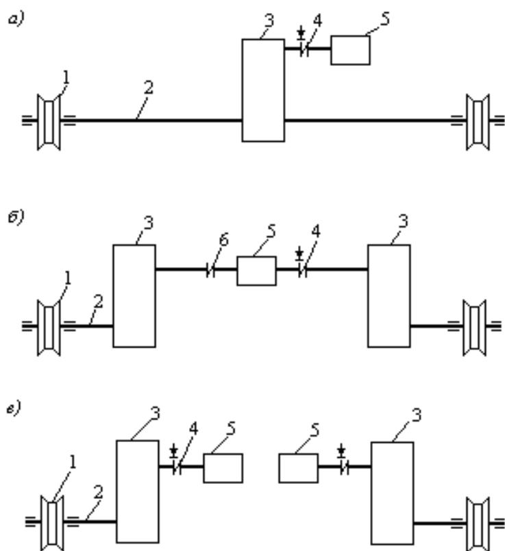
1 – ходовое колесо; 2 – вал; 3 – редуктор; 4 – тормоз; 5 – электродвигатель; 6 – муфта
