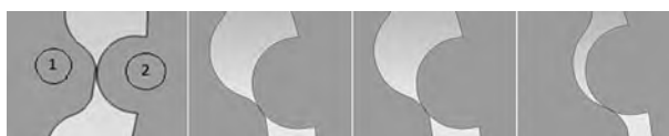
Рисунок 5 — Последовательность контактного взаимодействия с зубьями в виде ролика: 1 — зуб неподвижного центрального колеса; 2 — зуб сателлита с прямобочными профилями
