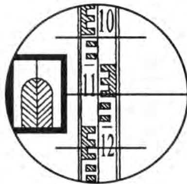
Рисунок 1.3 – Отсчет по нивелирной рейке
