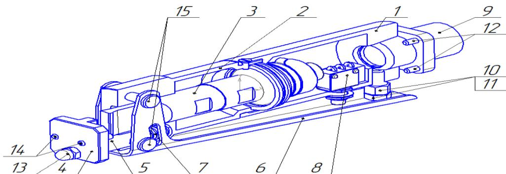
Рис. 1. Ультразвуковое устройство для герметизации полимерных трубок
