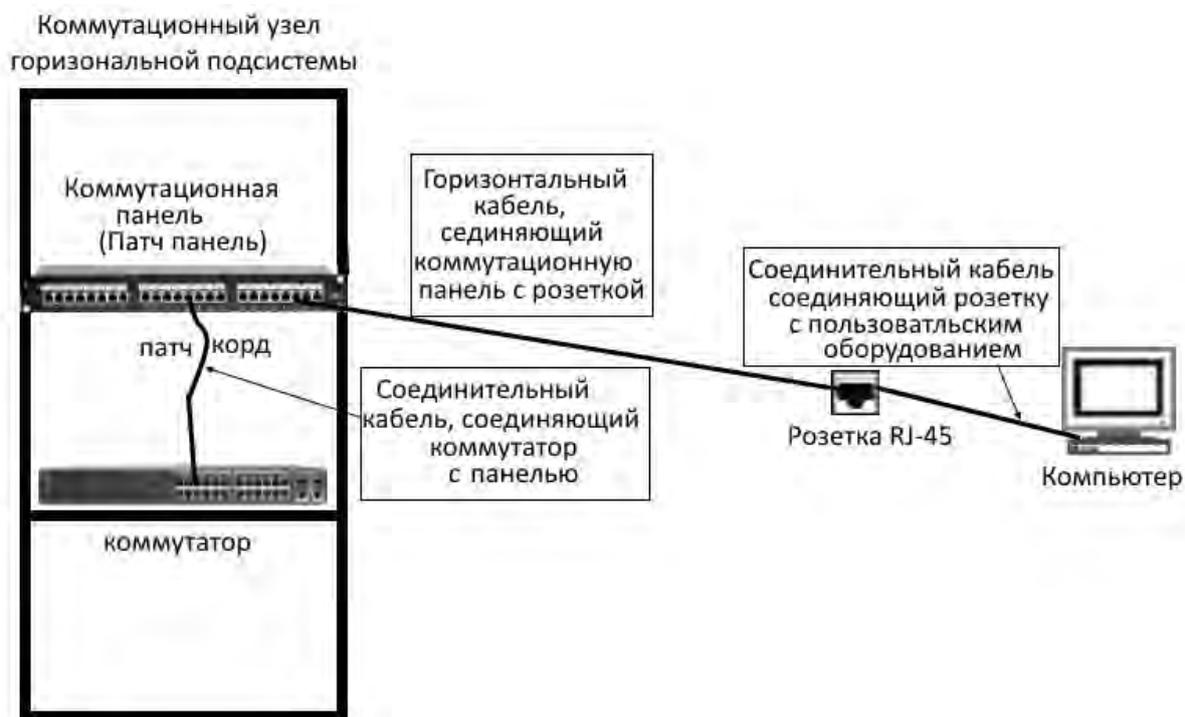
Рисунок 13 – Схема горизонтального уровня СКС
