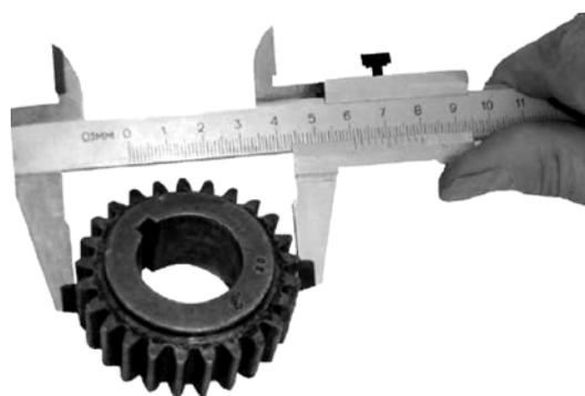
Рисунок 6 – Замер диаметра выступов колеса зубчатого
