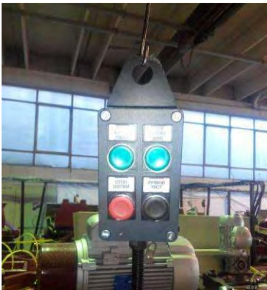
Рисунок 6.5 – Пульт управления ручной регулировки станка
