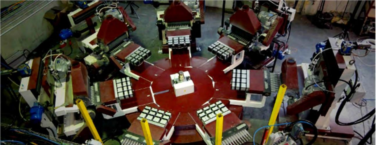
Рисунок 6.1 – Полировальная линия Pulimetal Cittadini TCLP 6+5+3
