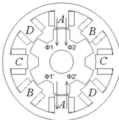
Рис. 1. Магнитное поле ВИМ
