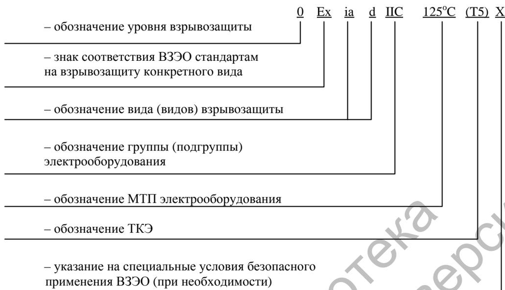
Рис. 3. Маркировка взрывозащиты ВЗЭО
