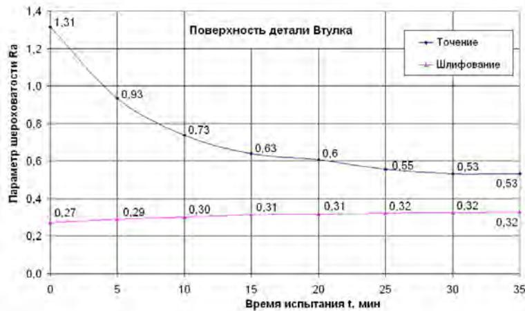
Рис. 1. Изменения параметра среднего арифметического отклонения профиля  $R_a$  поверхности детали втулка в процессе приработки
