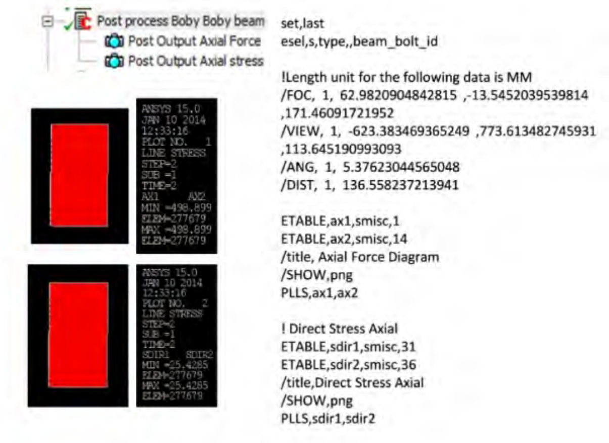
Рисунок 38 – Получение напряжения в болте, смоделированном опцией Beam Connection
