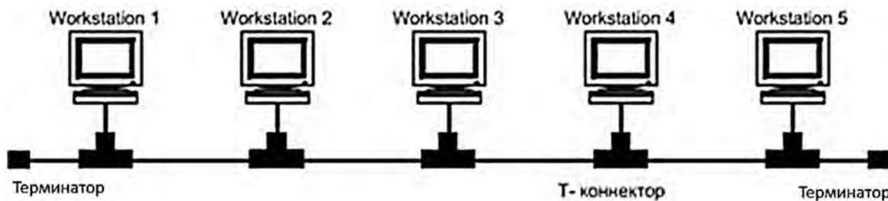
Рисунок 9.1 – Сетевая топология Шина
