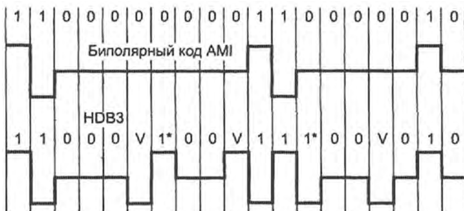
Рисунок 11.7 – Логическое кодирование (скремблирование) кодом HDB3
