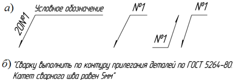
Рисунок 7 – Обозначение одинаковых сварных швов
