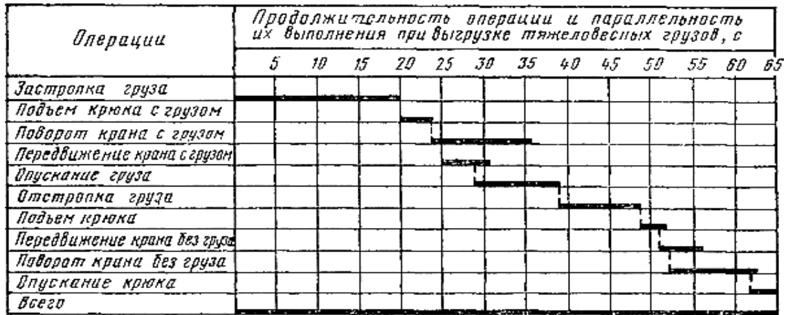
Рисунок Л.1 – График рабочего цикла стрелового полноповоротного крана на разгрузке тяжеловесных грузов
