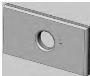
Рисунок 21 – Построенные скругления кромки отверстия (радиусом 3 мм) и стыка сторон бобышки (радиусом 5 мм) с помощью инструмента «СКРУГЛЕНИЕ»
