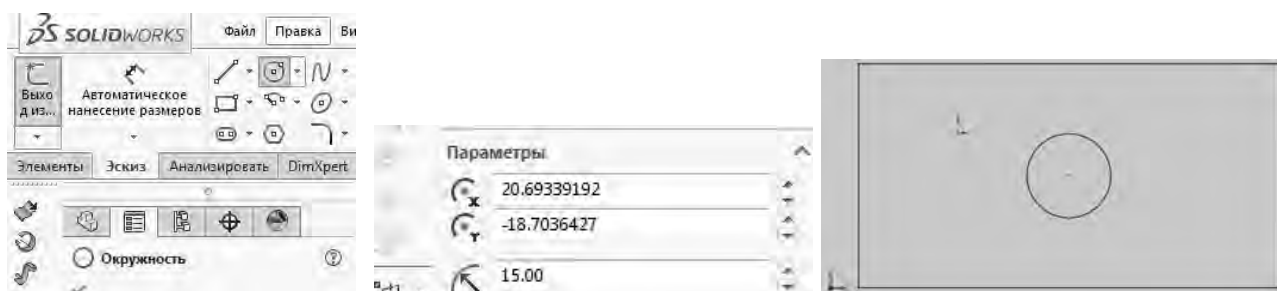
Рисунок 16 – Построение окружности заданного радиуса (15 мм) инструментом «ОКРУЖНОСТЬ» опции «ЭСКИЗ»
