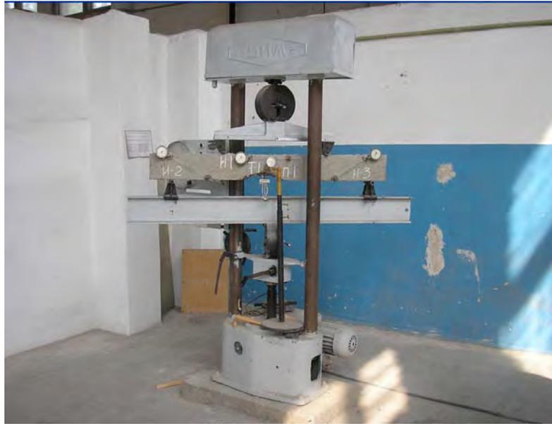
Рис. 2. Испытание опытных балок статическим нагружением
