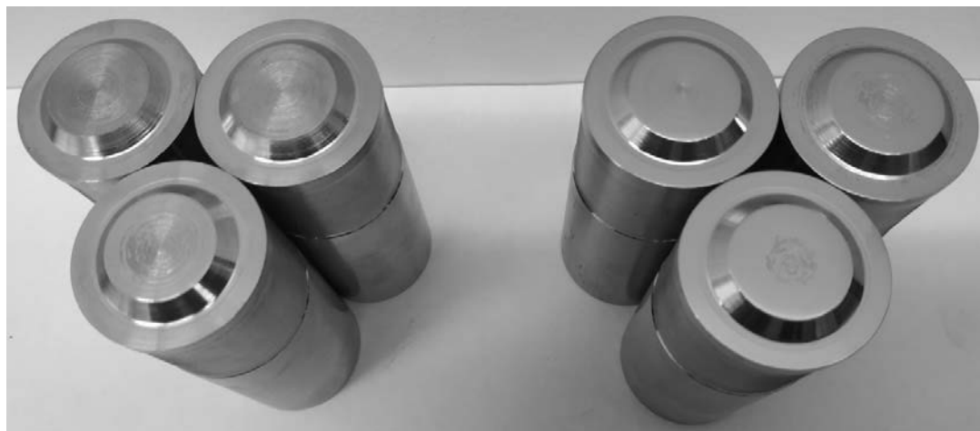
Рис. 1. Матрицы: слева – проточенные; справа – шлифованные
