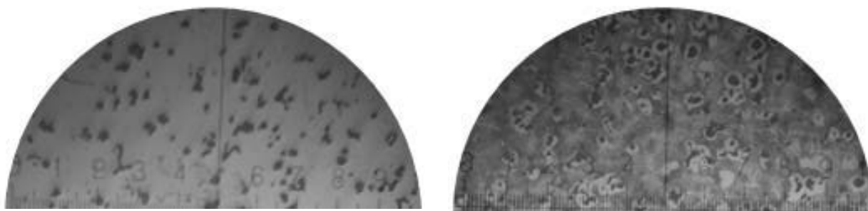
Рис. 1. Исходная структура отливок из низколегированного высокопрочного чугуна
