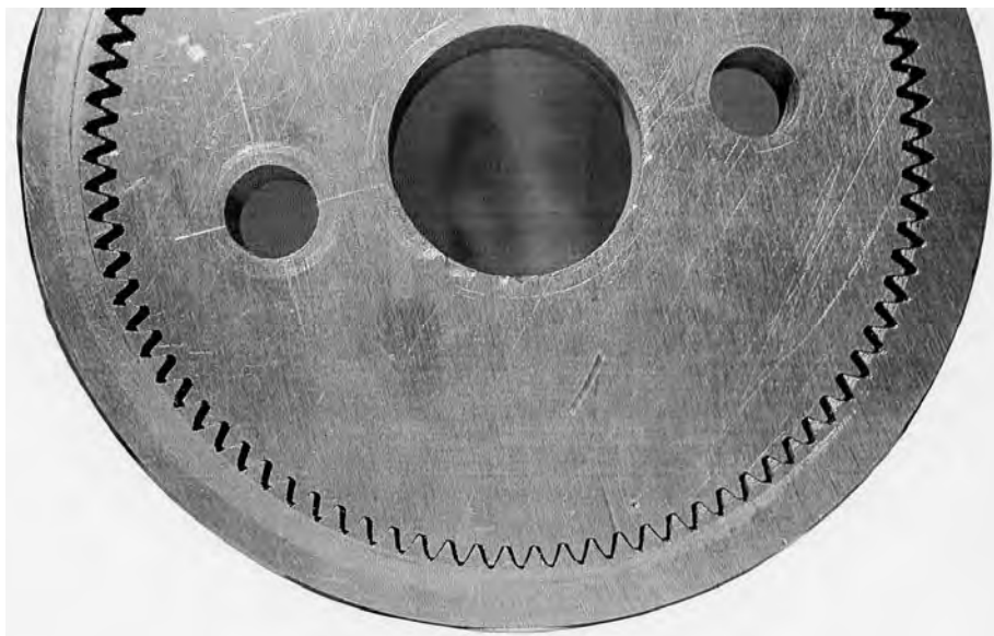
Рис. 2. Внутреннее зацепление с разностью чисел зубьев в один зуб
