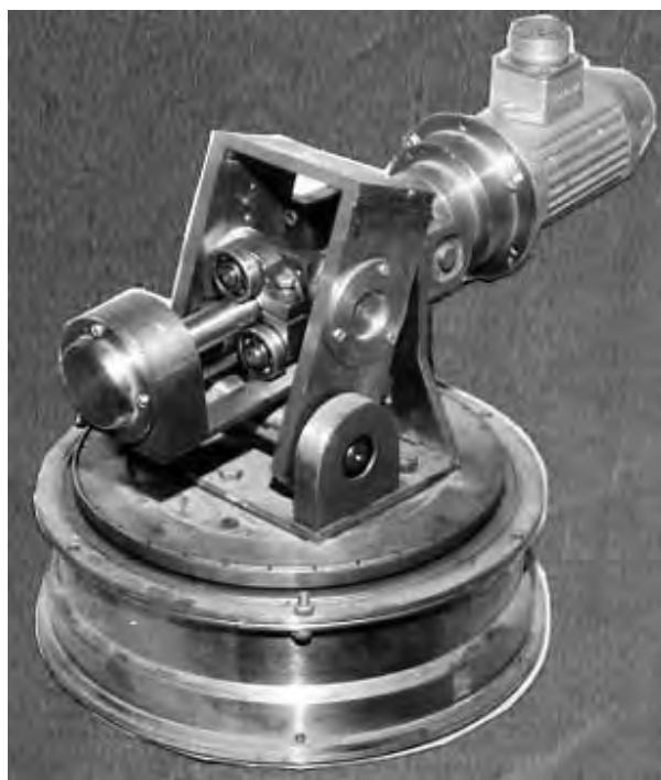
Рис. 3. Прецизионный модуль неполноповоротного движения с планетарной передачей в первой ступени
