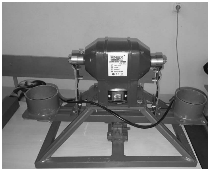
Рис. 2. Опытный образец балансирующей вибродисковой мельницы
