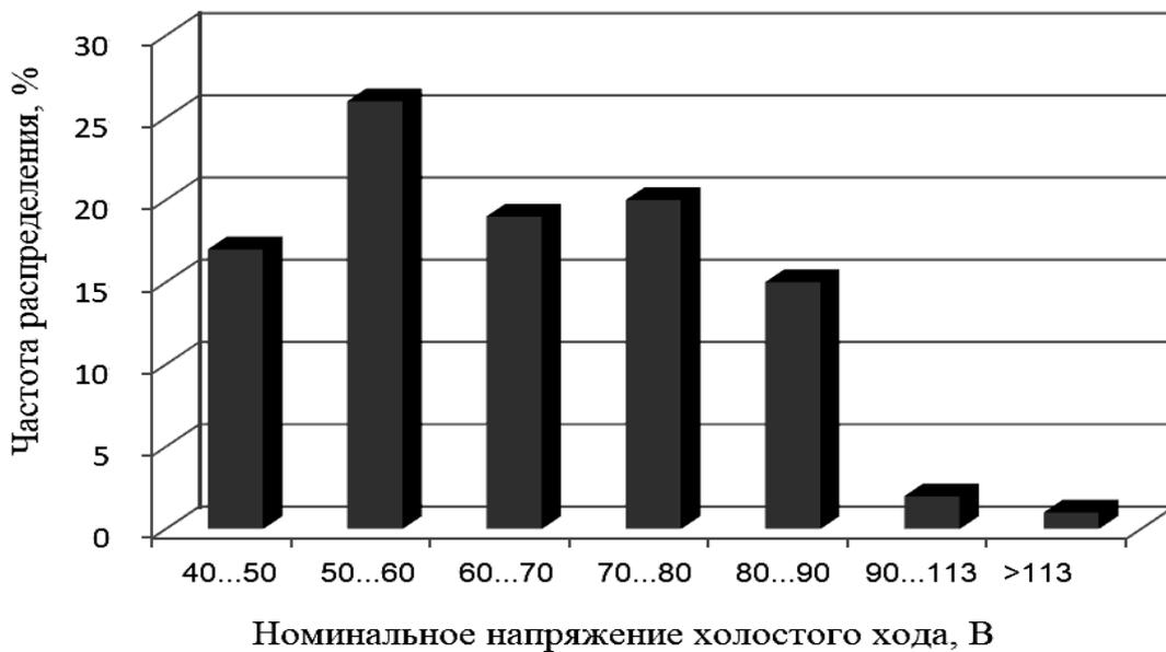
Рис. 6. Гистограмма частот распределения номинальных напряжений холостого хода
