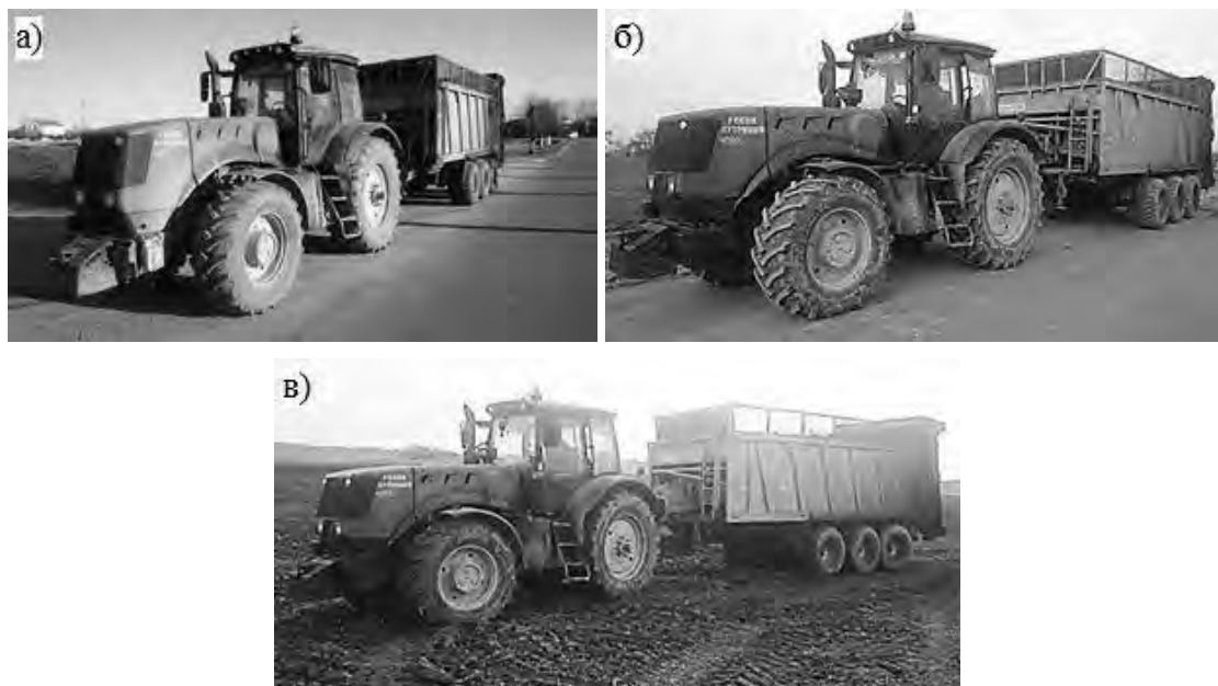
Рис. 5. Испытательные участки с разными типами поверхности передвижения: а – асфальтобетонная дорога; б – грунтовая (полевая) дорога; в – поле под посев
