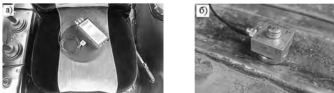
Рис. 6. Места установки датчика AP2038P-10: а – подушка сиденья; б – опорная поверхность для ног (пол кабины)
