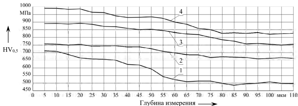
Рис. 6. Микротвердость поверхностного слоя после обработки тлеющим разрядом: 1 – стали У8; 2 – стали 5X3B3MFC; 3 – стали X12; 4 – стали Р6М5
