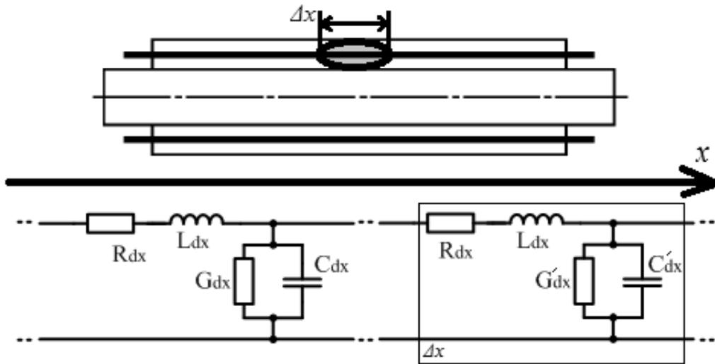
Рис. 1. Линия системы контроля и ее математическая модель
