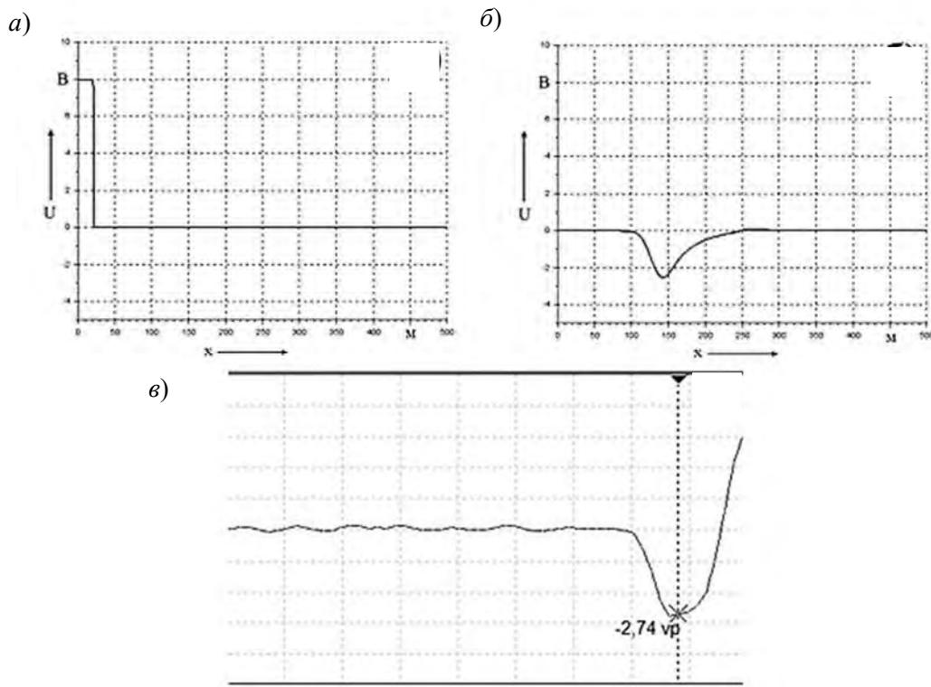
Рис. 4. Модель рефлектограммы трубопровода с дефектом: *a* – зондирующий импульс; *б* – отраженный импульс; *в* – рефлектограмма РЕИС
