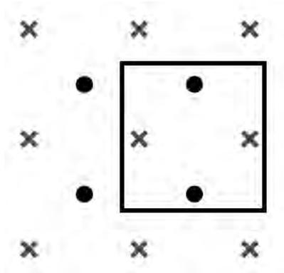
Рис. 3. Шаблон сетки: ● – узел напряжения; x – узел тока
