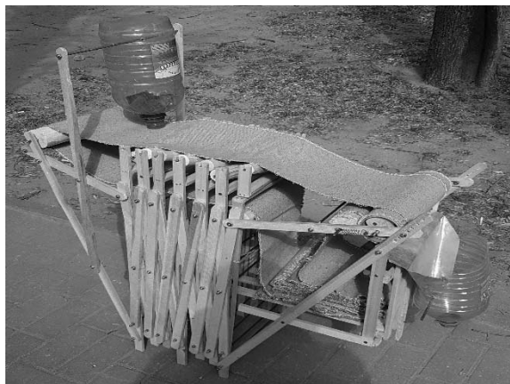
Рис. 1. Телескопический конвейер в сложенном положении
