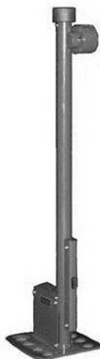
Рисунок 6.3 – Прибор определения коэффициента сцепления дорожных покрытий
