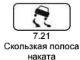
Рисунок 6.2 – Знак (а) и табличка (б), устанавливаемые при несоответствующих значениях коэффициента сцепления требованиям ТКП 45-3.03-19–2006 или ТКП 45-3.03-227–2010
