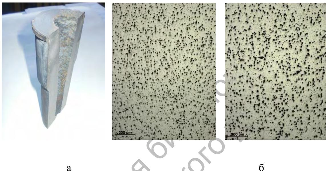
Рис. 1. Отливка с перепадом наружного диаметра, разрезанная вдоль образующей (а) и ее структура (б)
