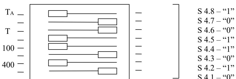
Рисунок 6.1 – Положения движков кодового переключателя S4
