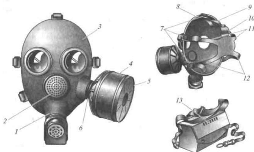
1 – узел клапана выдоха; 2 – переговорное устройство; 3 – лицевая часть; 4 – фильтрующе-поглощающая коробка; 5 – трикотажный чехол; 6 – узел клапана вдоха; 7 – пряжки; 8 – обтюратор; 9 – лобная лямка; 10 – наголовник; 11 – височная лямка; 12 – щечные лямки; 13 – сумка
