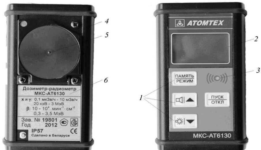
1 – мембранные панель управления; 2 – жидкокристаллический индикатор (ЖКИ); 3 – светодиодный индикатор; 4 – крышка-фильтр с магнитным фиксатором; 5 – метка центра детектора; 6 – этикетка с характеристикой прибора
