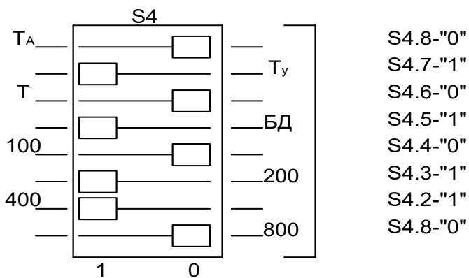
Рисунок 5.4 – Схема расположения движков кодового переключателя для измерений загрязненности поверхностей  $\beta$ -излучающими радионуклидами
