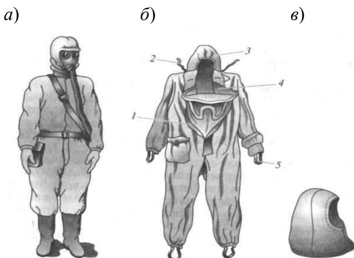
*a – общий вид; б – комбинезон:* 1 – нагрудный клапан; 2 – вздержки для затягивания капюшона; 3 – капюшон; 4 – горловой клапан; 5 – штрипки подрукавников; *в – подшлемник*
