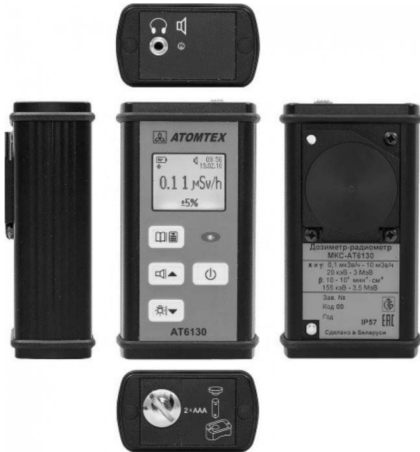
Рисунок 5.2 – Дозиметр-радиометр гамма- и бета-излучения МКС-АТ6130 АТОМТЕХ с поисковым режимом
