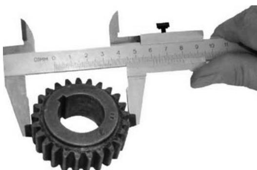
Рисунок 5.4 – Замер диаметра выступов колеса зубчатого
