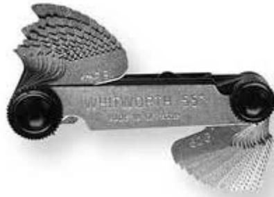
Рисунок 4.5 – Определение параметров резьбы
