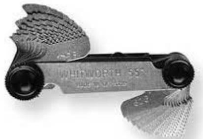
Рисунок 4.5 – Определение параметров резьбы
