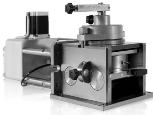
Рисунок 10.3 – Механизм срезной ГТ 2.2.3
