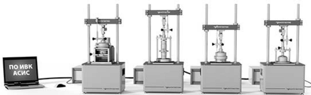
Рисунок 9.1 – Автоматизированный испытательный комплекс АСИС
