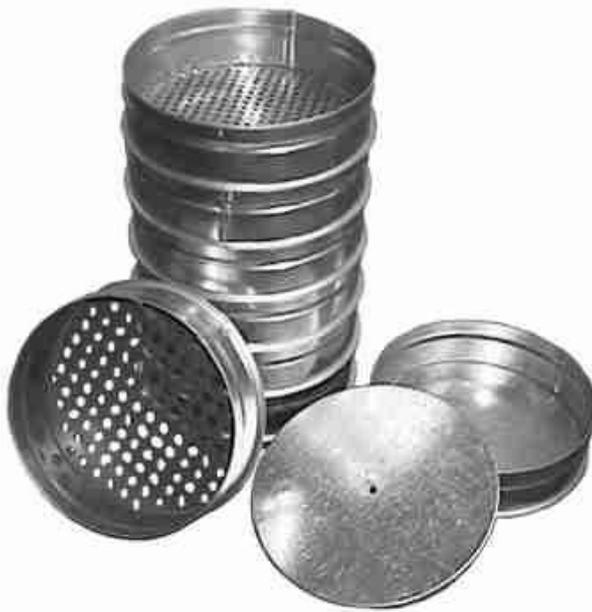
Рисунок 1.1 – Набор сит для определения гранулометрического состава
