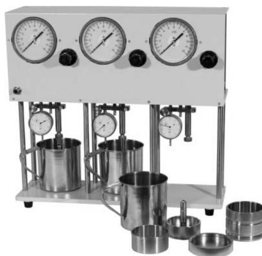
Рисунок 10.4 – Прибор предварительного уплотнения ГТ 1.2.5
