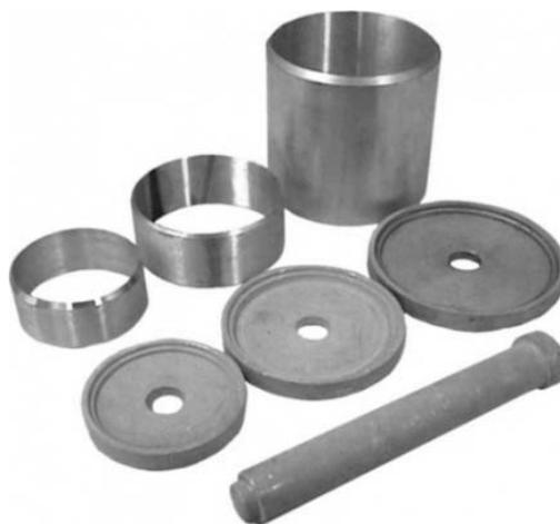
Рисунок 4.1 – Режущие кольца-пробоотборники
