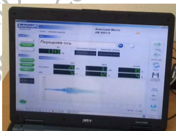
Рис. 3. Фотография диалогового окна с результатами испытаний микроавтобуса МАЗ на режиме «Подвеска»
