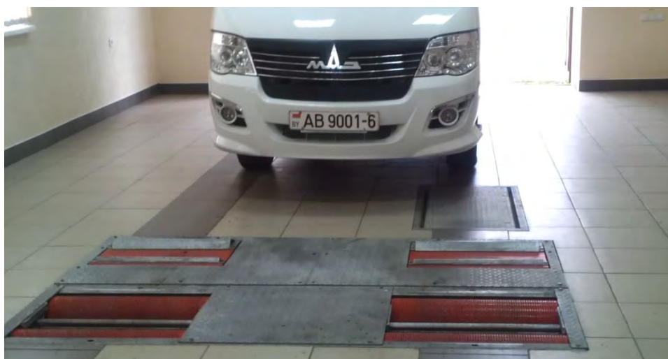
Рис. 2. Фотография микроавтобуса МАЗ на линии инструментального контроля технического состояния автомобилей Sherpa Safeline 3,5 PC-3 во время проведения испытаний
