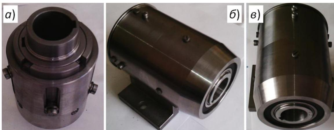
Рис. 1. Общий вид экспериментального образца редуктора: а – без корпуса; б, в – с корпусом
