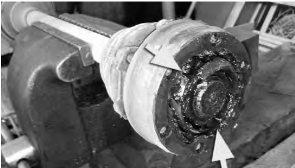
Рисунок 1.53 – Поломка сепаратора шарикового ШРУСа
