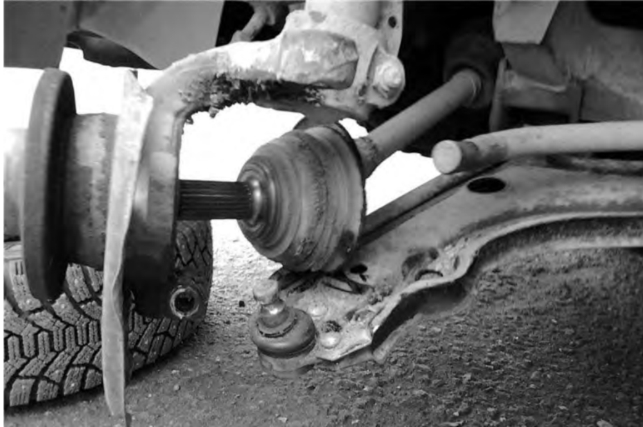
Рисунок 1.54 – Карданная передача равных угловых скоростей переднеприводного автомобиля
