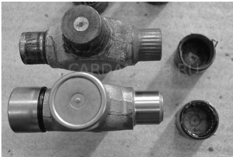
Рисунок 1.45 – Шейки крестовины до и после повреждения уплотнений
