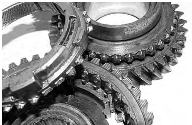
Рисунок 1.14 – Поломки зубьев блокирующего кольца и ведущей полумуфты
