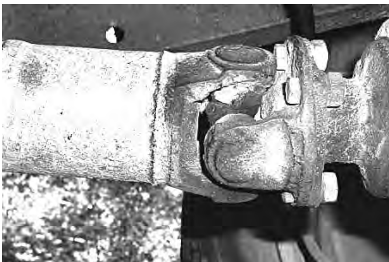
Рисунок 1.42 – Трещина вилки карданного шарнира
