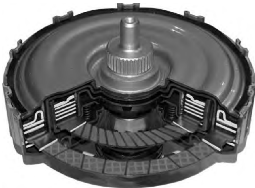
Рисунок 1.16 – Мокрое нормально разомкнутое сцепление преселективной коробки передач
