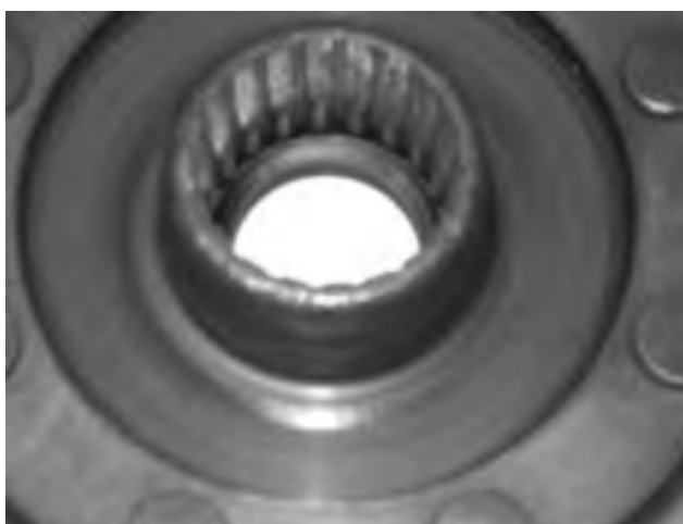
Рисунок 1.38 – Срезание шлицев втулки турбинного колеса трансформатора и первичного вала коробки передач
