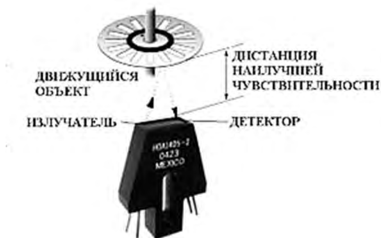
Рисунок 2.5 – Принцип работы оптического датчика угловой скорости, работающего по методу отражения
