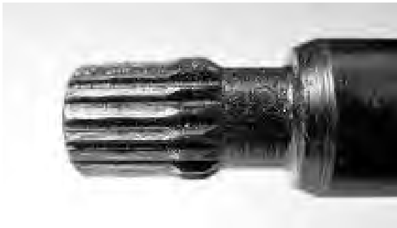
Рисунок 1.73 – Износ шлицевого конца полуоси
