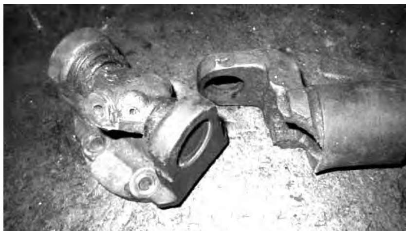
Рисунок 1.44 – Поломка вилки и крестовины карданного вала
