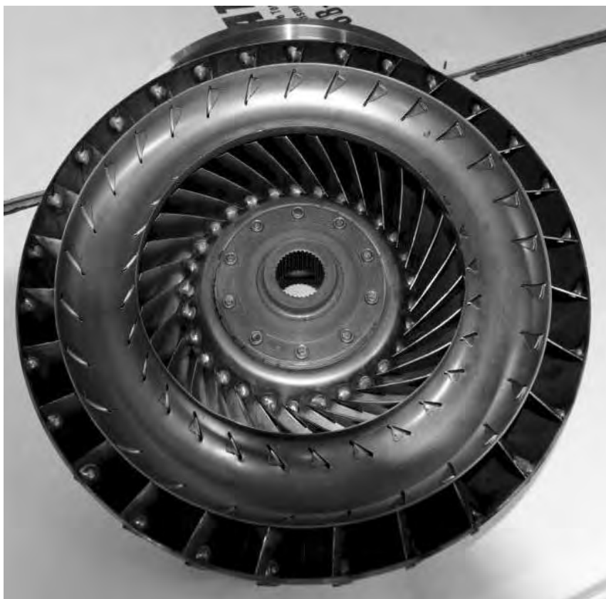
Рисунок 1.35 – Конструкция гидротрансформатора из штампованных колес
