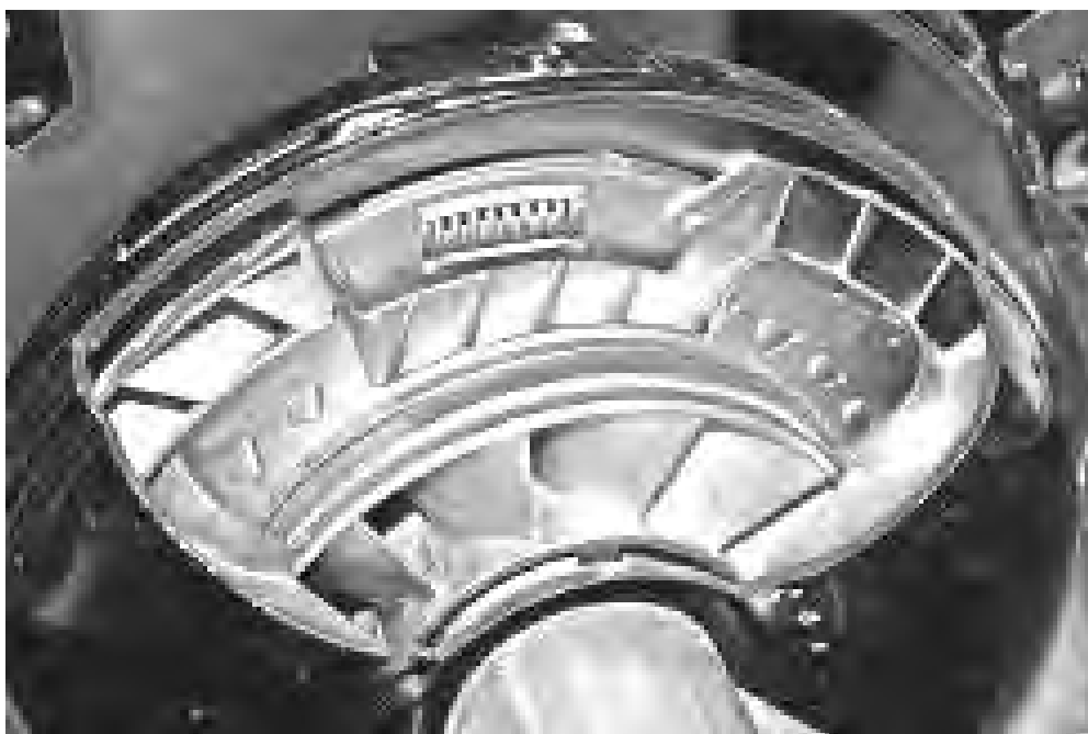
Рисунок 1.34 – Размещение гасителя крутильных колебаний во фрикционе блокировки гидротрансформатора
