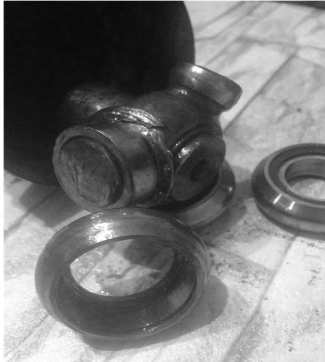
Рисунок 1.57 – Дефекты трехшипового шарнира равных угловых скоростей
