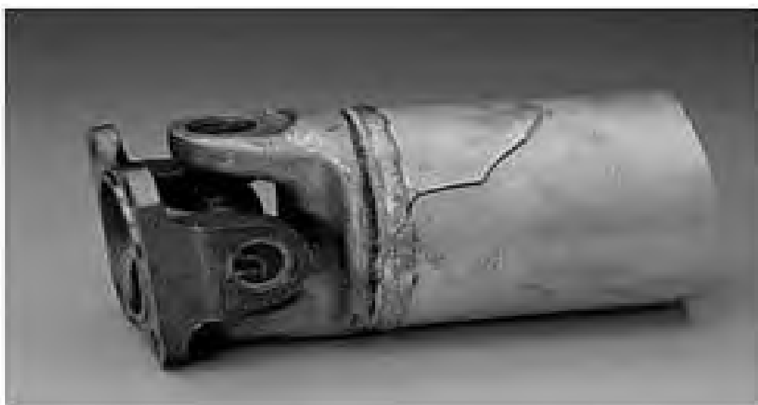
Рисунок 1.46 – Трещина карданного вала
