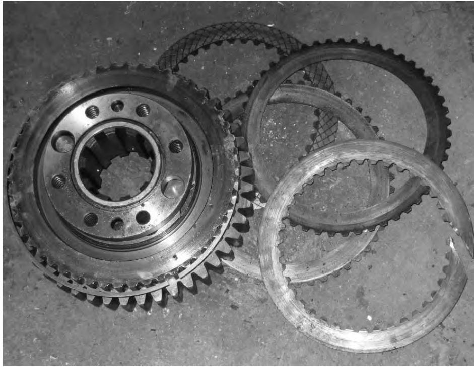
Рисунок 1.27 – Разрыв диска фрикциона
