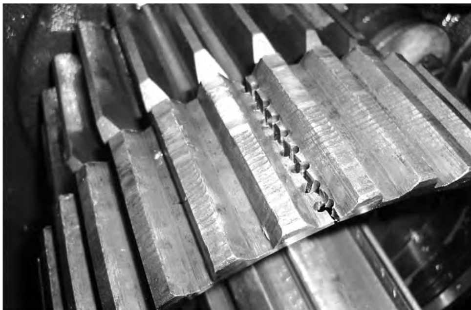
Рисунок 1.24 – Разрушение ведомой части фрикциона от перегрузки
