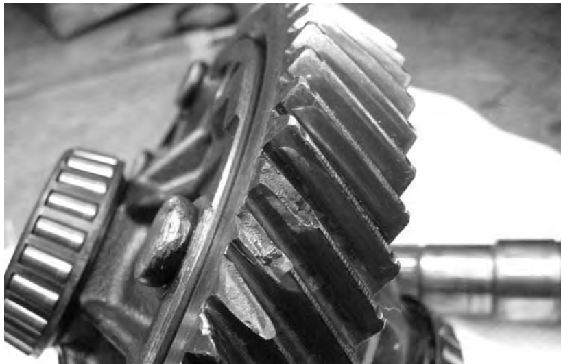
Рисунок 1.61 – Обломы зубьев ведомого колеса главной передачи переднеприводного автомобиля
