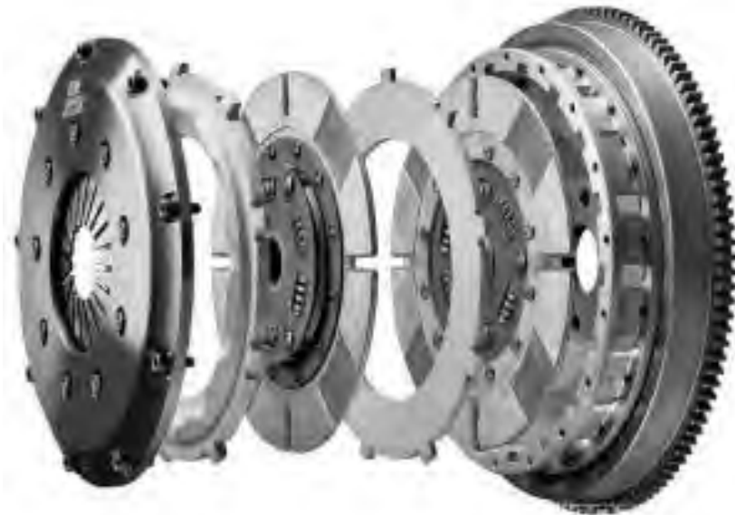
Рисунок 1.15 – Двухдисковое сухое нормально замкнутое сцепление с центральной тарельчатой пружиной
