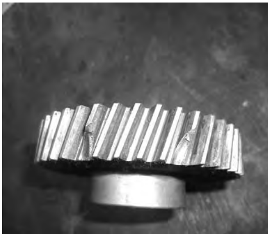
Рисунок 1.9 – Обломы зубьев косозубых передач
