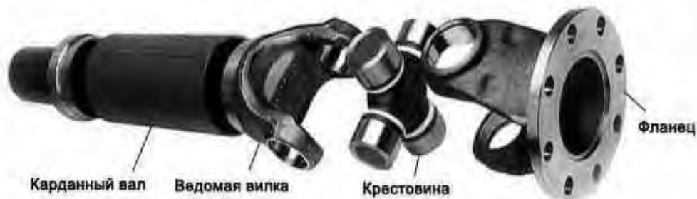
Рисунок 1.41 – Одна часть карданной передачи неравных угловых скоростей
