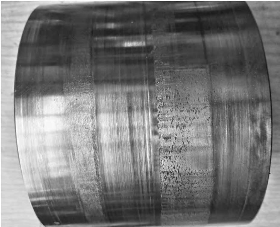
Рисунок 1.32 – Выкрашивание поверхностей обоймы муфт свободного хода комплексного гидротрансформатора
