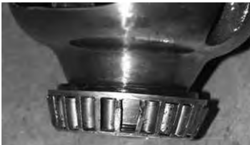
Рисунок 1.62 – Истирание ролика подшипника главной передачи переднеприводного автомобиля при его заклинивании
