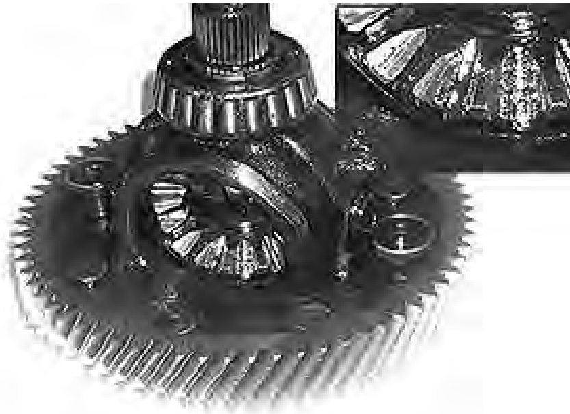
Рисунок 1.66 – Разбивание зубьев шестерни полуоси и сателлита в месте постоянного контакта при прямолинейном движении
