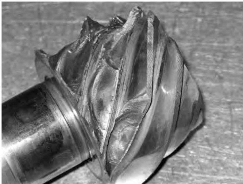
Рисунок 1.64 – Дефекты зубьев ведущей шестерни гипоидной передачи
