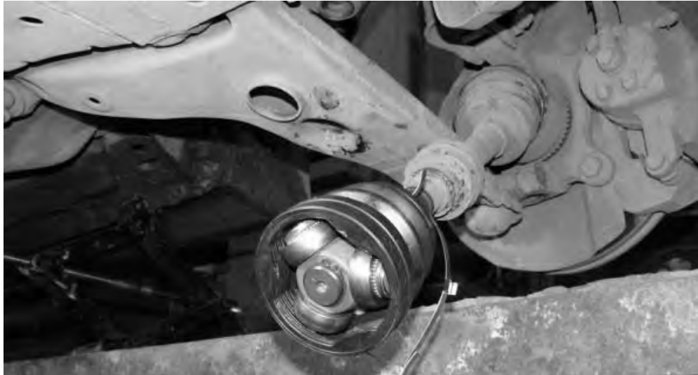
Рисунок 1.52 – Конструктивное исполнение трехшипового шарнира равных угловых скоростей
