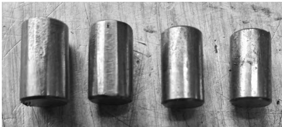
Рисунок 1.33 – Следы питтинга на поверхностях роликов муфты свободного хода
