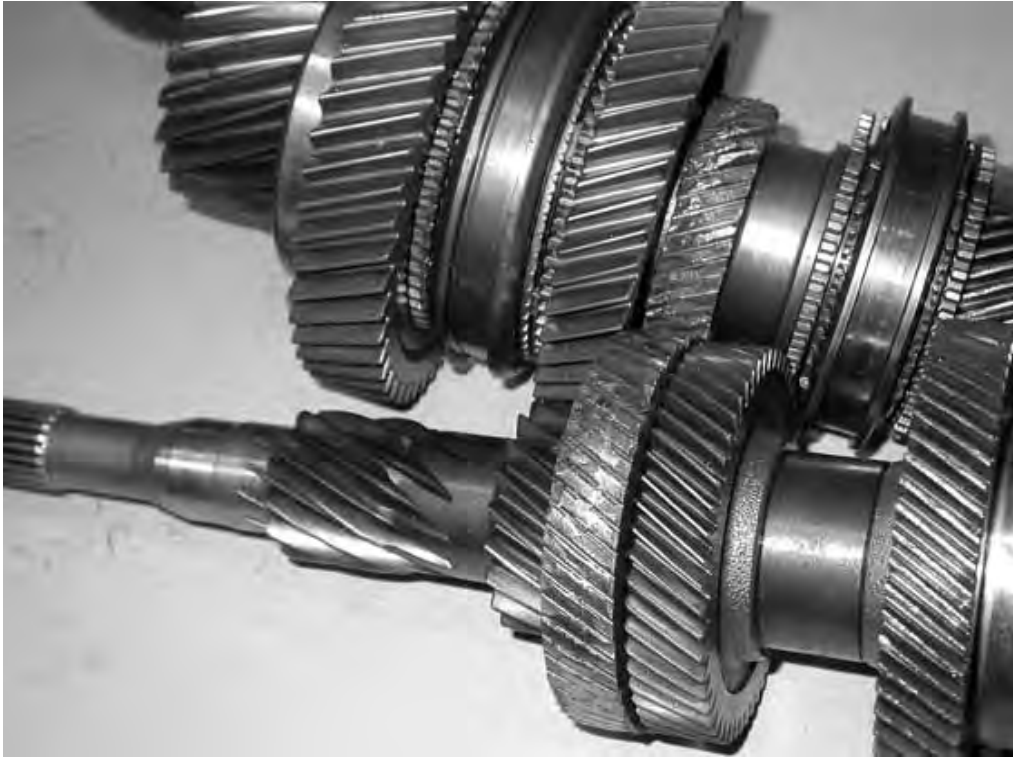
Рисунок 1.10 – Разрушение зубчатой пары из-за поломки зуба
