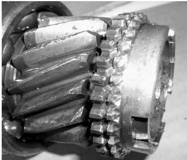
Рисунок 1.12 – Износ шлицев и внутренней конической поверхности блокирующего кольца
