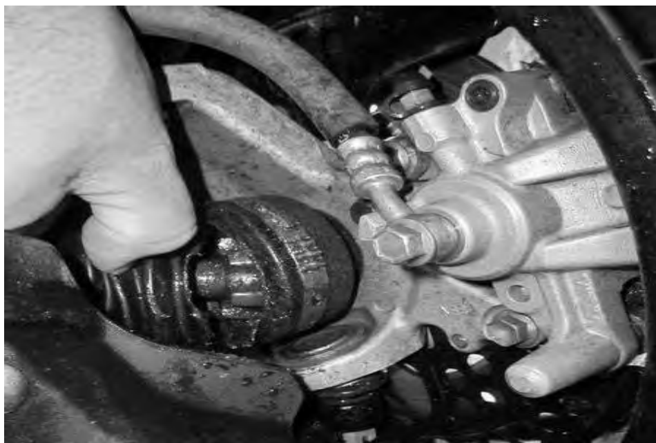
Рисунок 1.56 – Повреждение грязезащитного чехла ШРУСа
