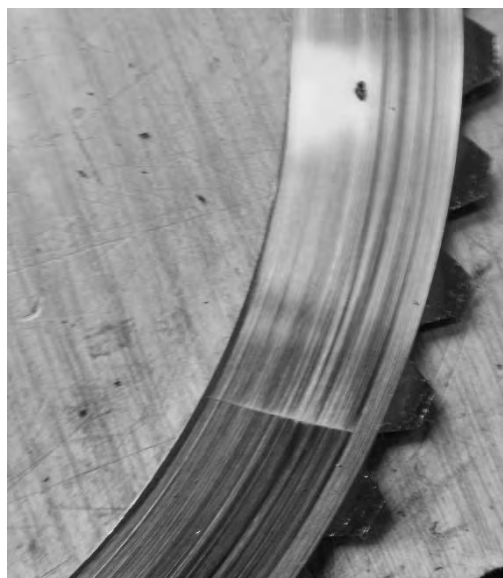
Рисунок 1.26 – Трещины дисков фрикциона
