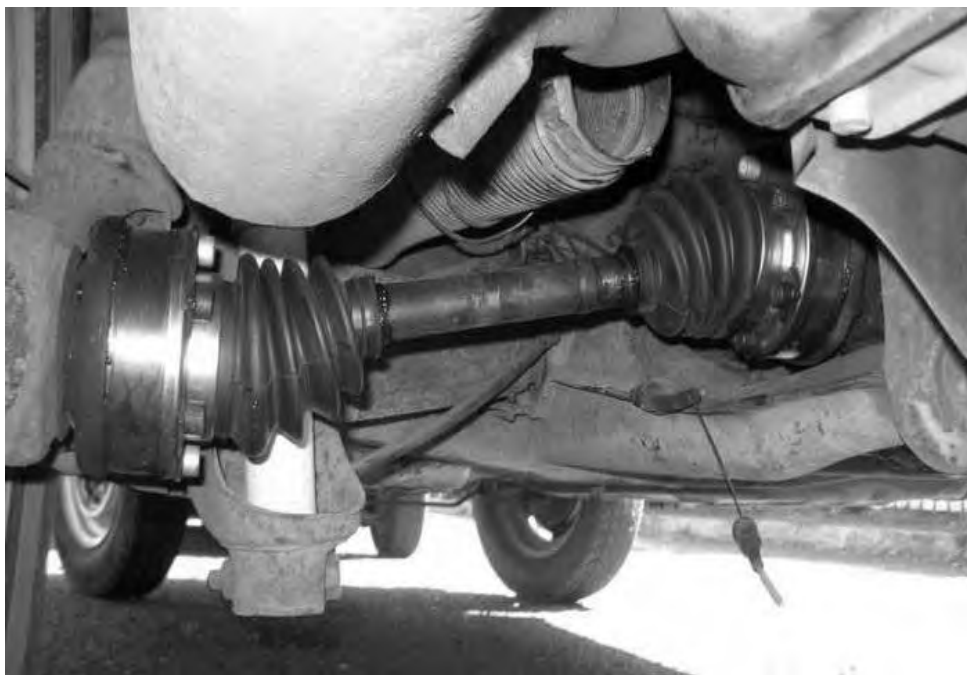
Рисунок 1.55 – Карданная передача равных угловых скоростей заднеприводного автомобиля
