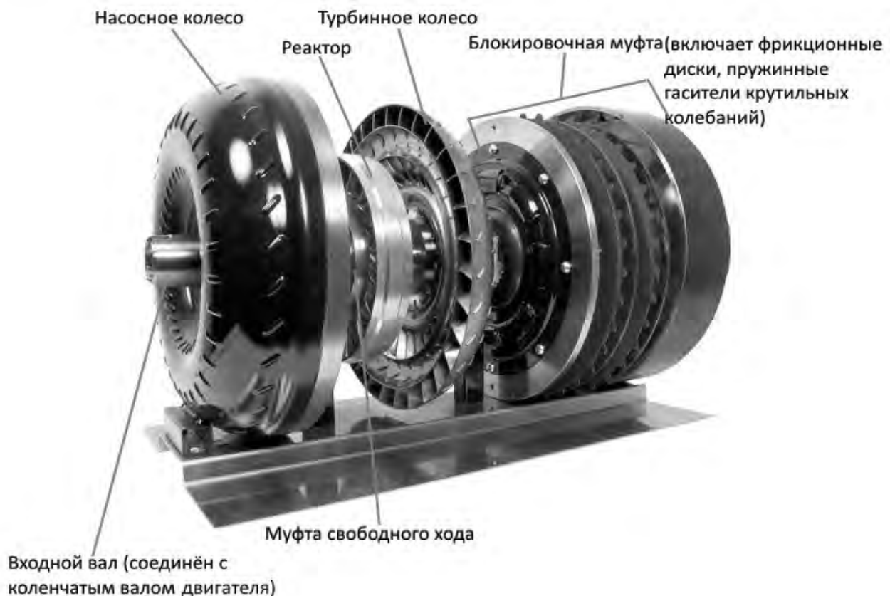
Рисунок 1.29 – Гидродинамический трансформатор
