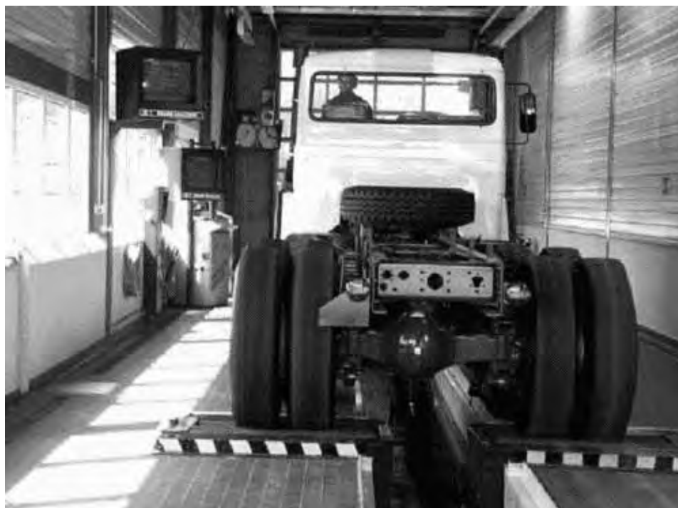
Рисунок 2.3 – Роликовый тормозной стенд для грузовых автомобилей с максимальной нагрузкой на ось до 18 т IW 7/E немецкой фирмы «МАН»
