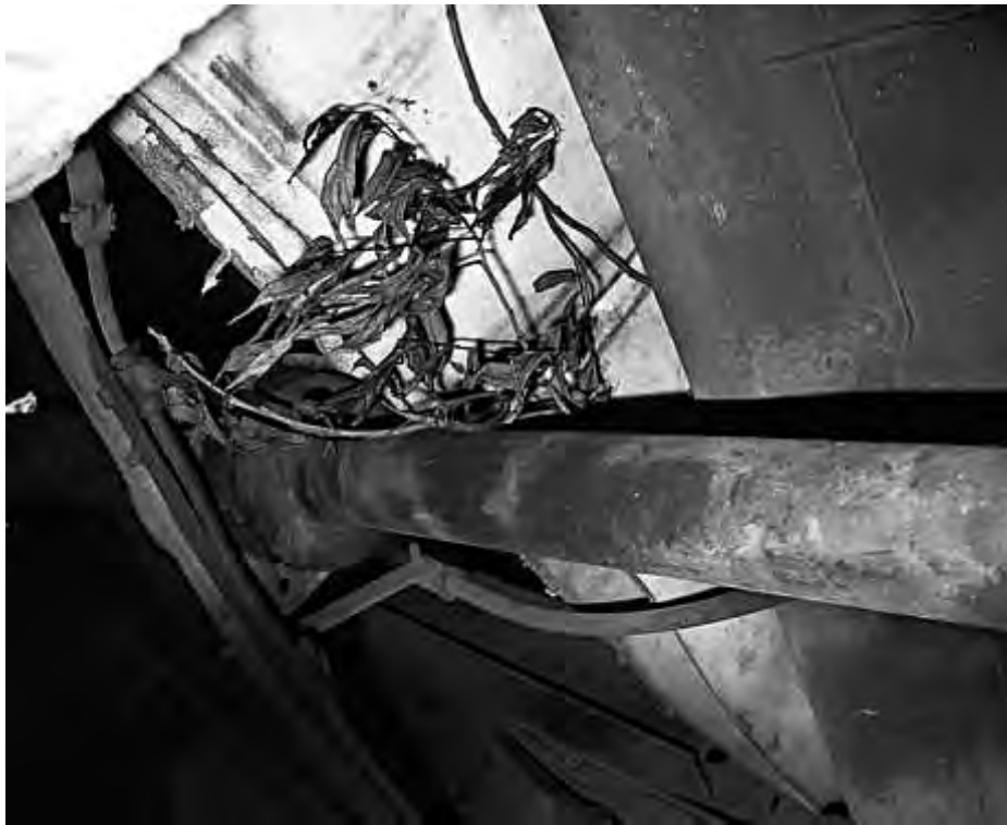
Рисунок 1.39 – Наматывание на карданную передачу веток деревьев
