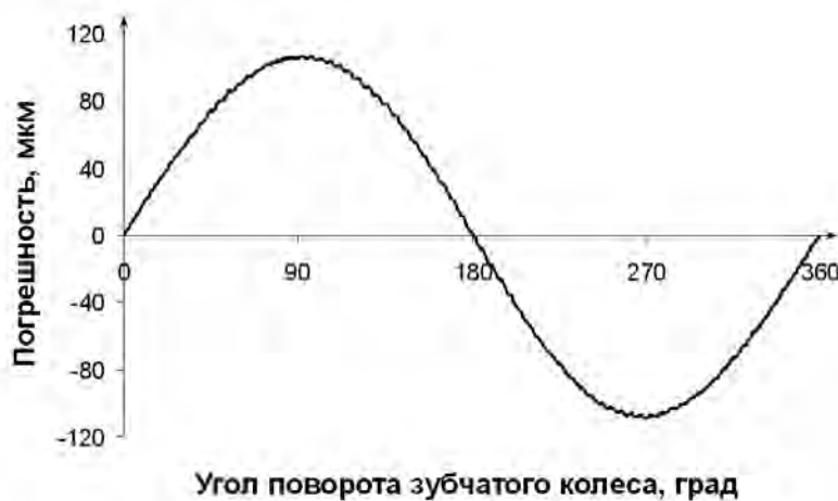
Рис. 5. График кинематической погрешности колеса, ось заготовки которого была смещена при обработке
