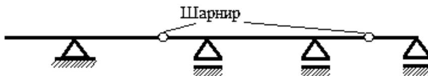
Рис. 3.10. Многопролетная шарнирная балка
